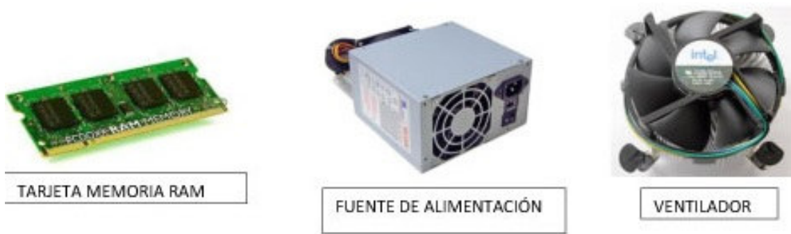
Imagen nº 5. Otros componentes de la placa base. Autor: Elaboración propia
