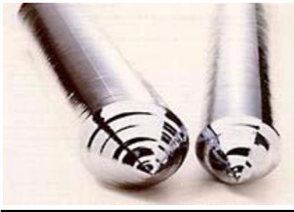
Lingotes de silicio ultrapuro empleados en la fabricación de componentes electrónicos
